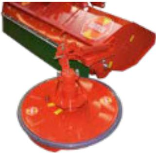
Schwenkscheibe mit Motor, Ausladung ab Seitenteil vom Mulcher
