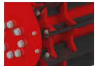
Die Laufwalze Cut-Roller mit beweglichen Messern, zerdrückt und zerschneidet ebenfalls die Ernterückstände. Sie ist besonders für trockene und sandige Böden geeignet.
