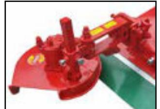
Mechanische Steuerung für Mulchkopf
