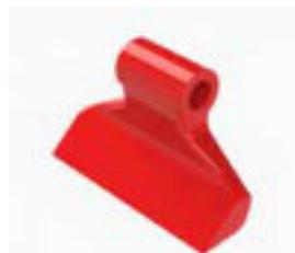
Der Universalschlegel mit seinem 1,4 kg Eigengewicht, ist ein Allround-Schlegel. Er eignet sich zum Mulchen und zum Holzzerkleinern (Holzstärken bis 5 cm). Die Schlegels sind aus einer hochvergüteten Legierung geschmiedet, was die notwendige Standzeit des Werkzeuges garantiert.
