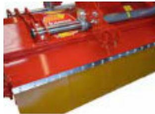
Zusätzlicher Gummi-Steinschlag-schutz im Heckbereich
