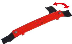
Pro Messerkreisel sind zwei frei pendelnde Messerklingen am Messerträger montiert, welche schnell und kostengünstig austauschbar sind. Durch die lineare Arbeitsbreiteneinstellung wird ein großer Überschneid erreicht. Dies führt zu einem exakten und sauberem Schnittbild.
