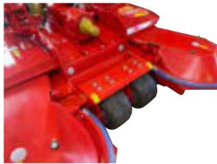
Schwenkräder Front gummiert, ausgeschäumt, kugelgelagert (Art.-Nr. 331.90.603) 515,- €
